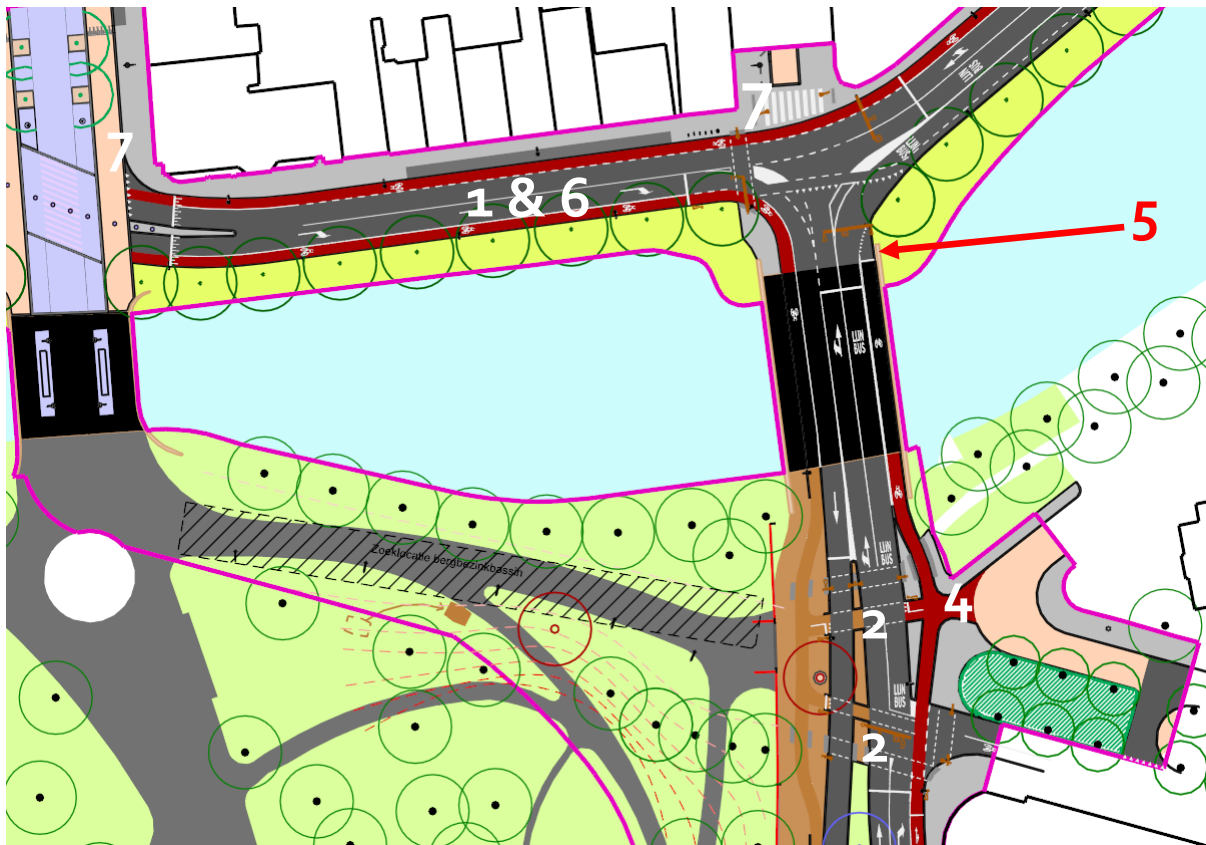
Figuur 4.4 – Nieuw ontwerp verkeerssituatie rondom stationsgebied voor NHTV fietsroute (bron: Breda.nl) De nummers komen overeen met de onderstaande voor- en nadelen.
